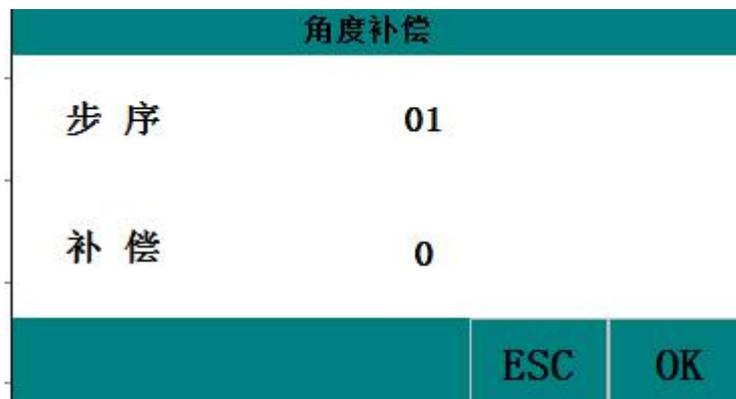
摇动手轮到正确位置，点击确定，补偿值自动写入当前工件的程序中。
